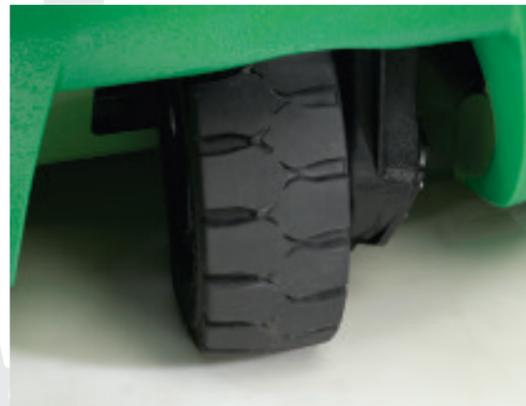
La possibilità di ruotare di 180° la monoruota posteriore, e le dimensioni contenute della macchina, consentono un'ottima manovrabilità anche negli spazi ristretti e in ridotti corridoi di stivaggio.
